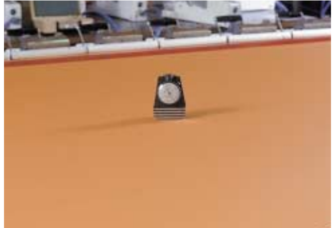
Рис. 7.4. Правильно калиброванный тестер гарантирует одинаковое натяжение ткани.
