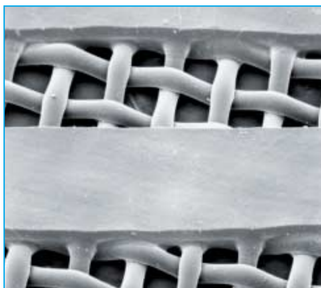
Рис. 4.1. Идеальный трафарет имеет плоскую поверхность и резкие края, которые образуют угол 90° с поверхностью ткани и подложкой.
