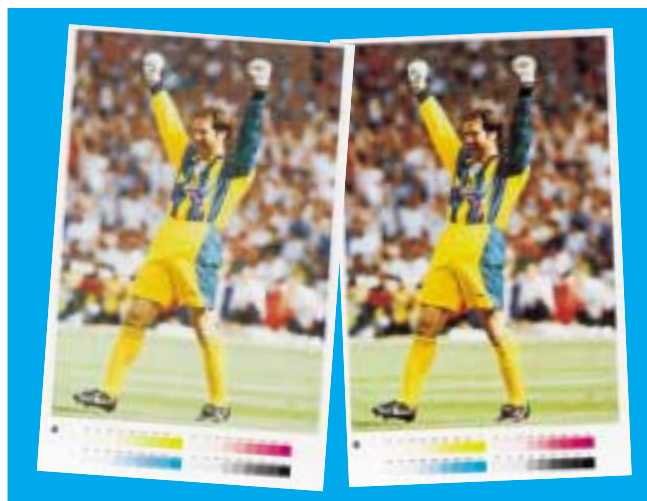
Рис. 6.1. Оба отпечатка были произведены используя одинаковые трафареты. В то время как левый отпечаток близко соответствует пробному, правый показывает результаты использования неправильного профиля, угла и давления ракеля.
