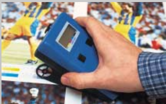
Рис. 3.13. Денситометр — возможно наиболее полезный прибор для трафаретного печатника, поскольку он позволяет производить точное измерение цветов, предоставляя Вам возможность определять точную степень растискивания растровой точки в каждой области шкалы тонов.
