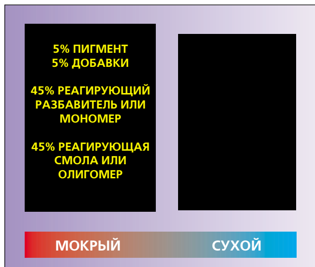
Рис. 5.3. Составные части традиционных красок с УФ-отверждением и красочный слой после сушки.
